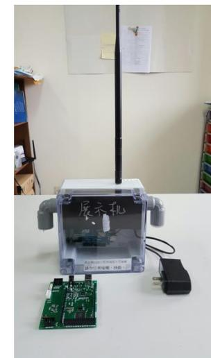
監測點的外殼材料是一般水電行可購買到的材料，並且在設計上具備防水與防蚊蟲的功能。此一規劃是希望方便民眾自行組裝與檢修，並且能長期置放在走廊與屋簷下。到目前為止的實地測試中，監測點外殼雖然粗獷，但是非常實用。相信學生可以透過實際操作、製作感測器的過程，學習運用科技解決身旁實際問題的重要能力。
